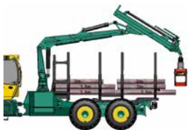
Zwillingsrunge schnellwechselbar für 2 x 2 oder 2 x 2,5 m Holz (nicht bei 805F Kurzversion)
