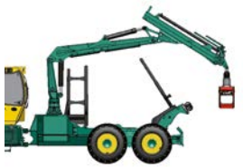
Seilrückung möglich ohne Umbau der Runge
