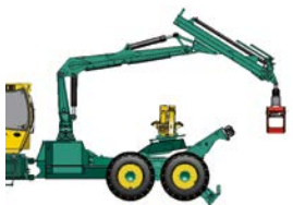
Seilrückung möglich ohne Umbau der Klemmbank
